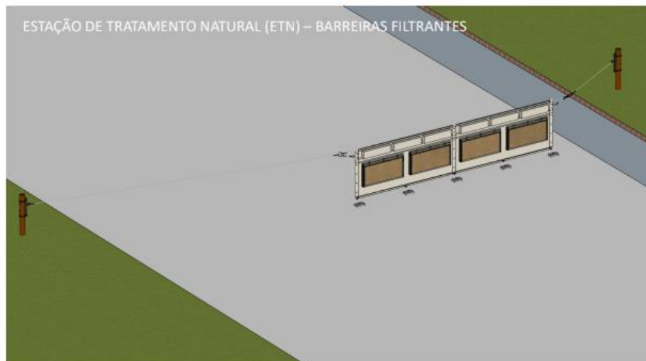
Figura 27: Arranjo geral da instalação do Sistema de Tratamento Natural.
