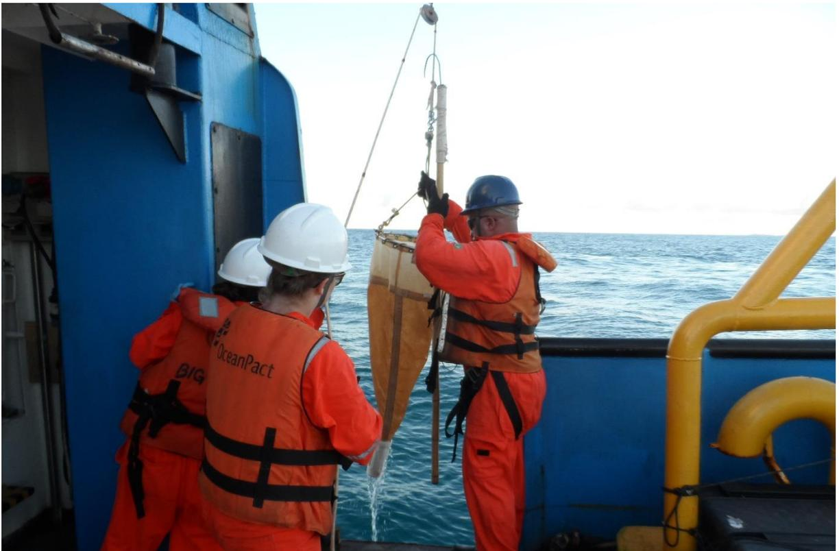
Figura 9: Lançamento de draga de Van Veen para amostragem sedimentar de fundo.
