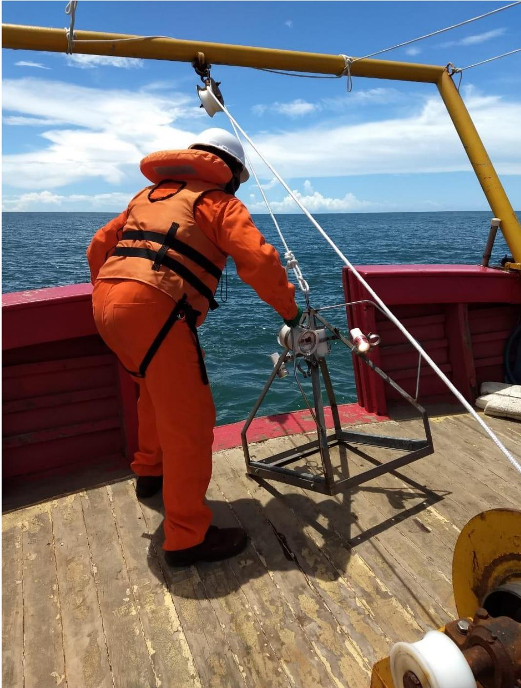
Figura 12: Lançamento do SVP (perfilador de velocidade do som) para correção de dados batimétricos.
