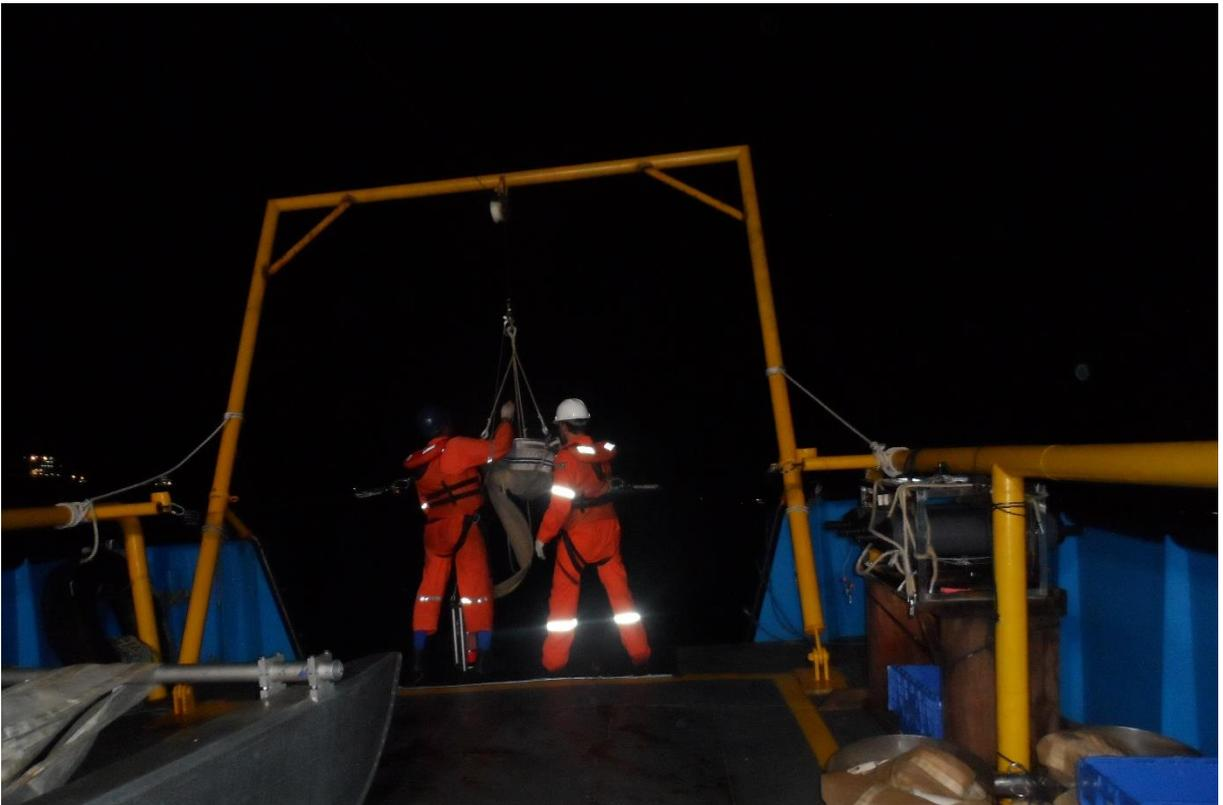
Figura 5: Lançamento de CTD para perfilagem ao longo da coluna d'água.
