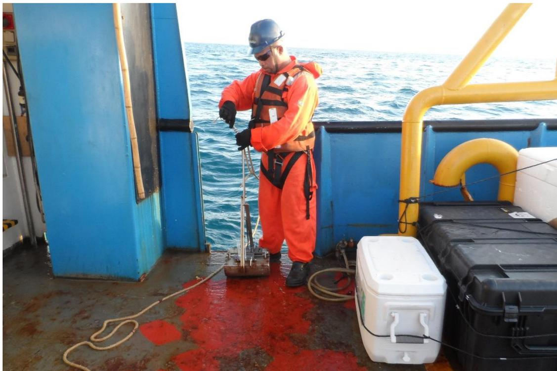
Figura 10: Lançamento de Boomer para levantamento sísmico.
