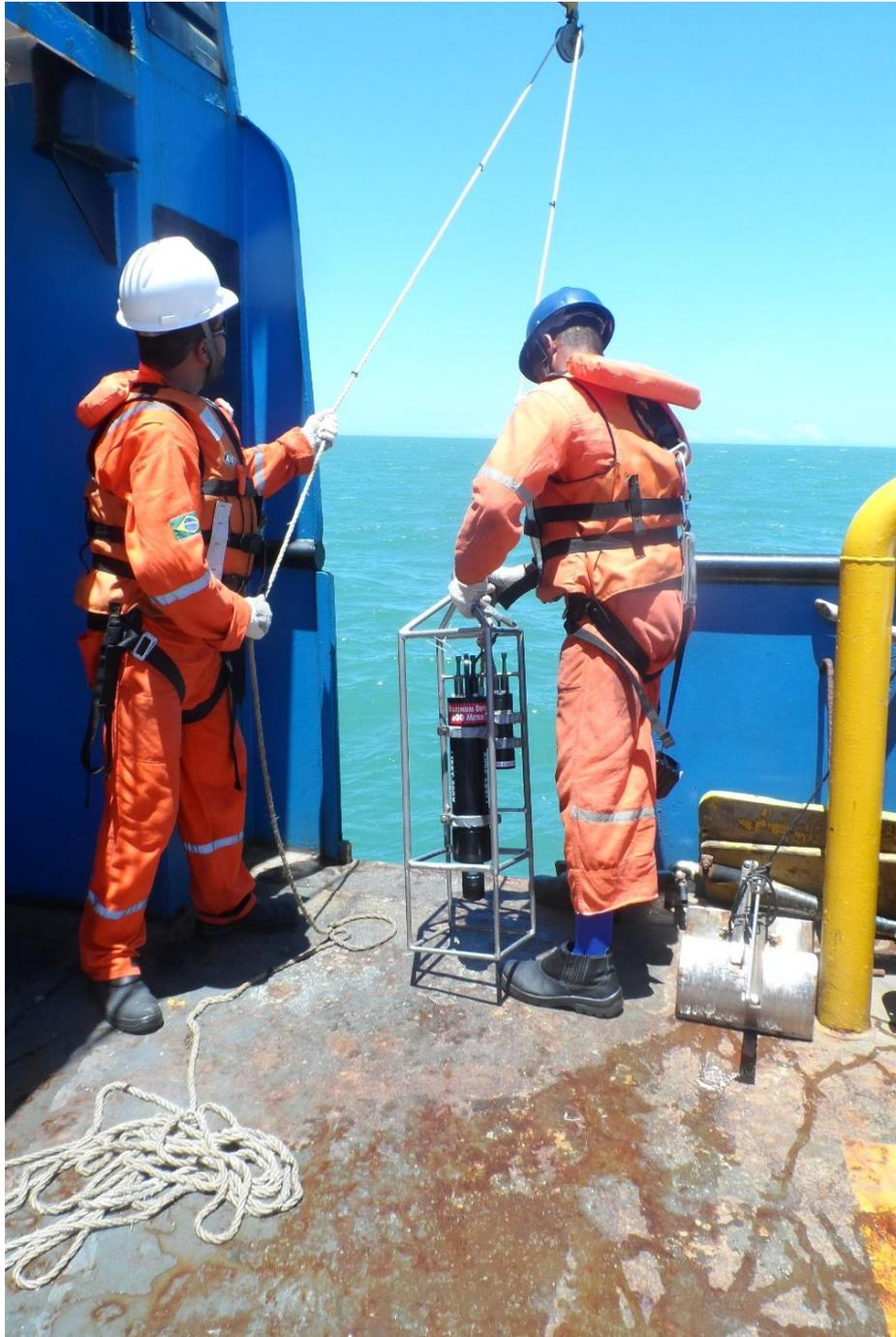
Figura 3: Lançamento do rack de garrafas de Van Dorn para amostragem de água ao longo da coluna d'água.
