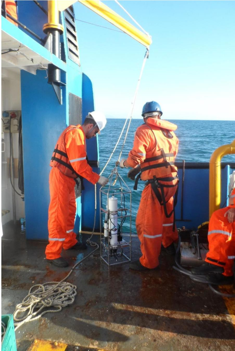
Figura 6: Lançamento de hidrorradiômetro para perfilagem da irradiância ao longo da coluna d'água.
