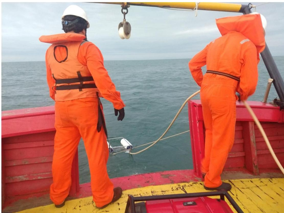
Figura 11: Lançamento de dropcam para imageamento do fundo.
