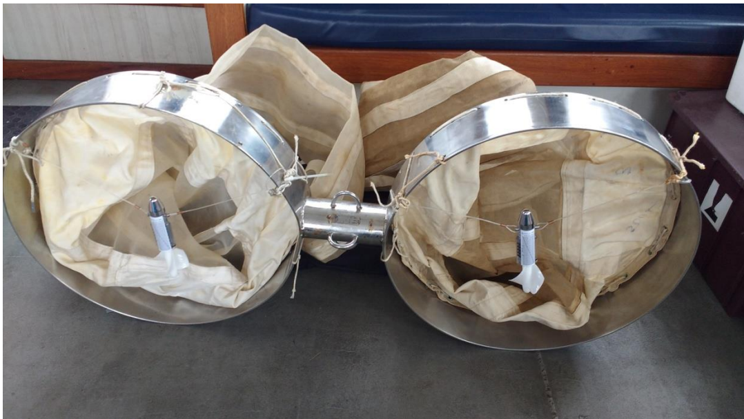
Figura 2: Rede bongô utilizada nos arrastos noturnos do ictioplâncton.
