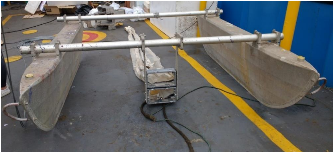
Figura 1: Rede neustônica utilizada nas amostragens subsuperficiais do ictioplâncton.
