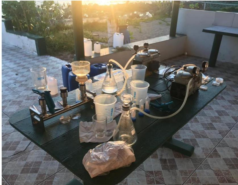
Após retornar da campanha, os filtros foram colocados em estufa para secagem, e pesados individualmente para se obter o peso total final do filtro. Esse valor, subtraído do valor do filtro seco obtido anteriormente na preparação de coleta, indicará o peso da amostra. O peso dividido pelo volume filtrado resultará na concentração do MPS (mg/L). Esse valor será usado para a calibração dos valores obtidos através das imagens de satélite através da comparação dos valores.
