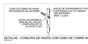
DETALHE - CONEXÃO DE HASTE COM CABO DE COBRE NU
