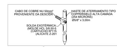
DETALHE - CONEXÃO DE HASTE COM CABO DE COBRE NU
