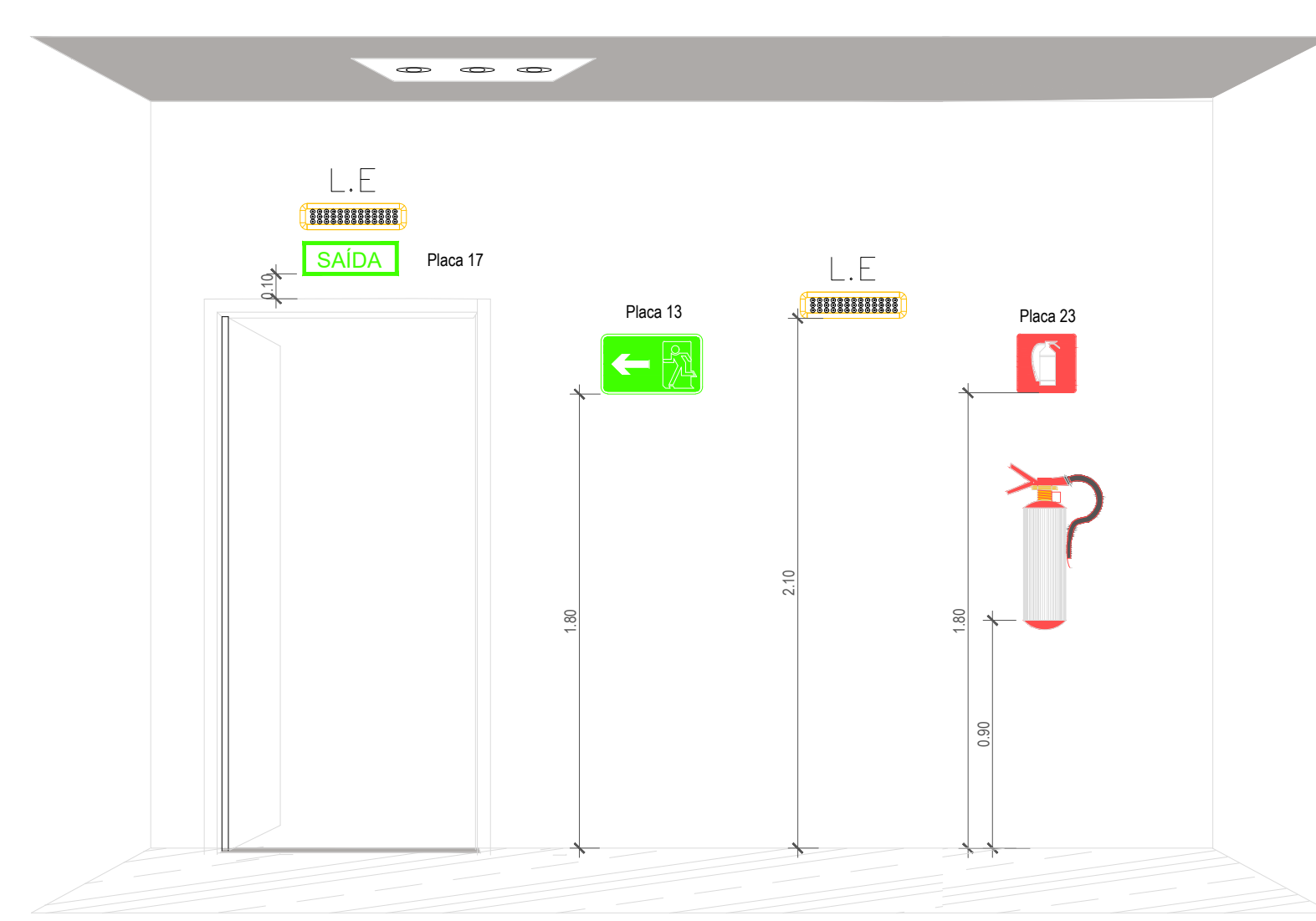
DETALHE INSTALAÇÕES SINALIZAÇÃO DE EMERGÊNCIA ESCALA 1:25
