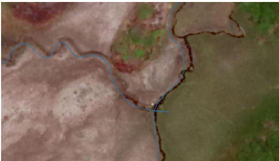
Figura 18: Trechos de drenagem que se cruzam e necessitam ser quebrados
