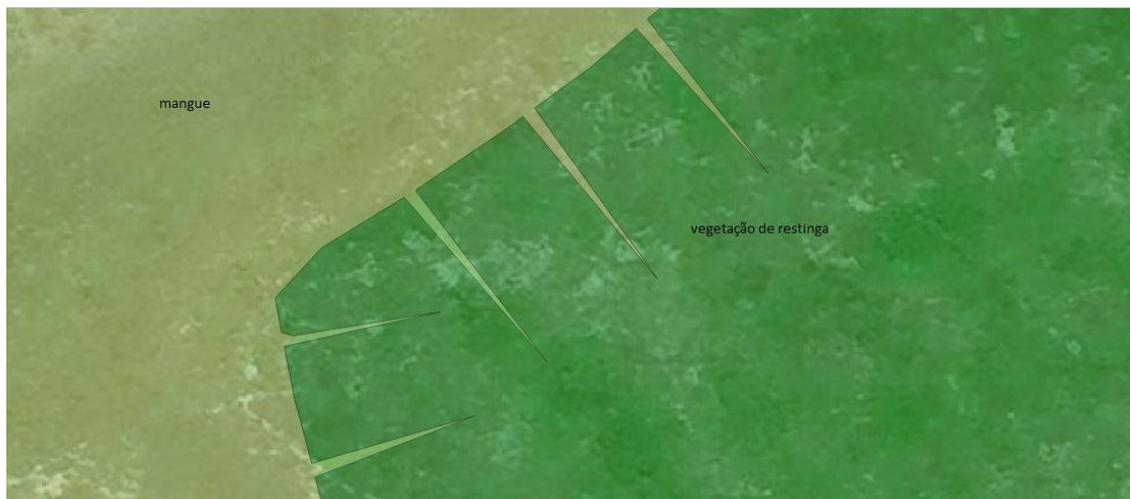
Figura 15: ângulos fora da tolerância no limite entre tipos de vegetação
