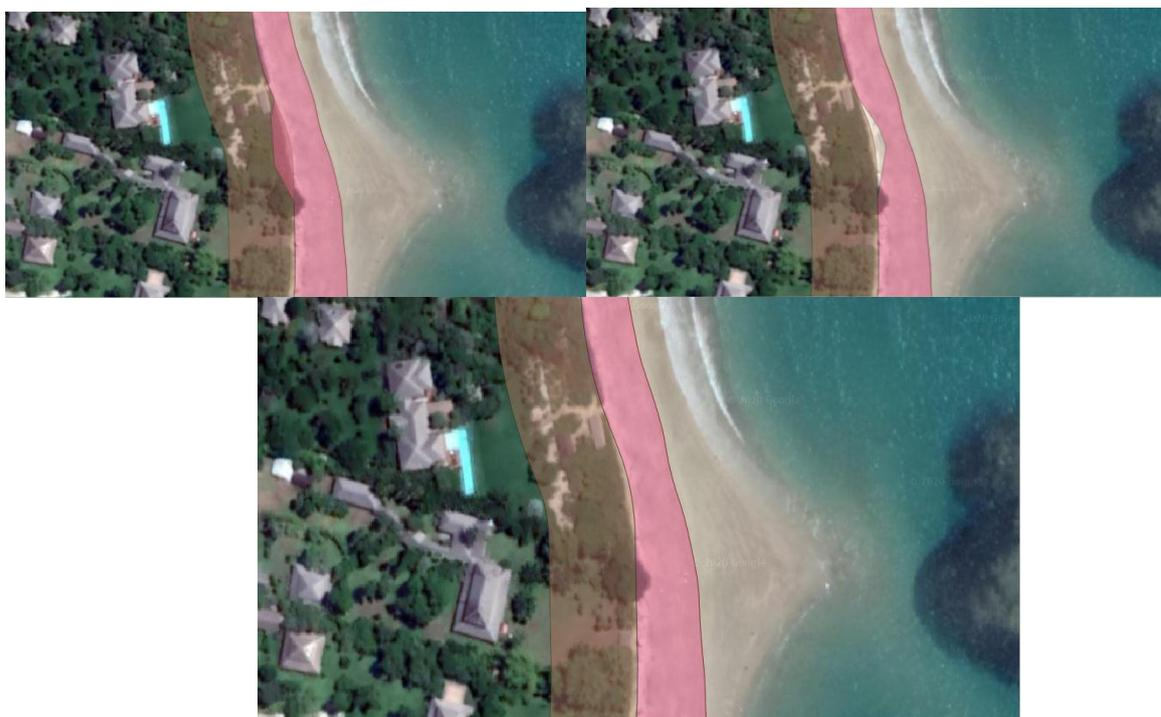
Figura 18: Processo de Eliminação de Sobreposições e "Buracos" (Antes e Depois da Execução do Processo)
