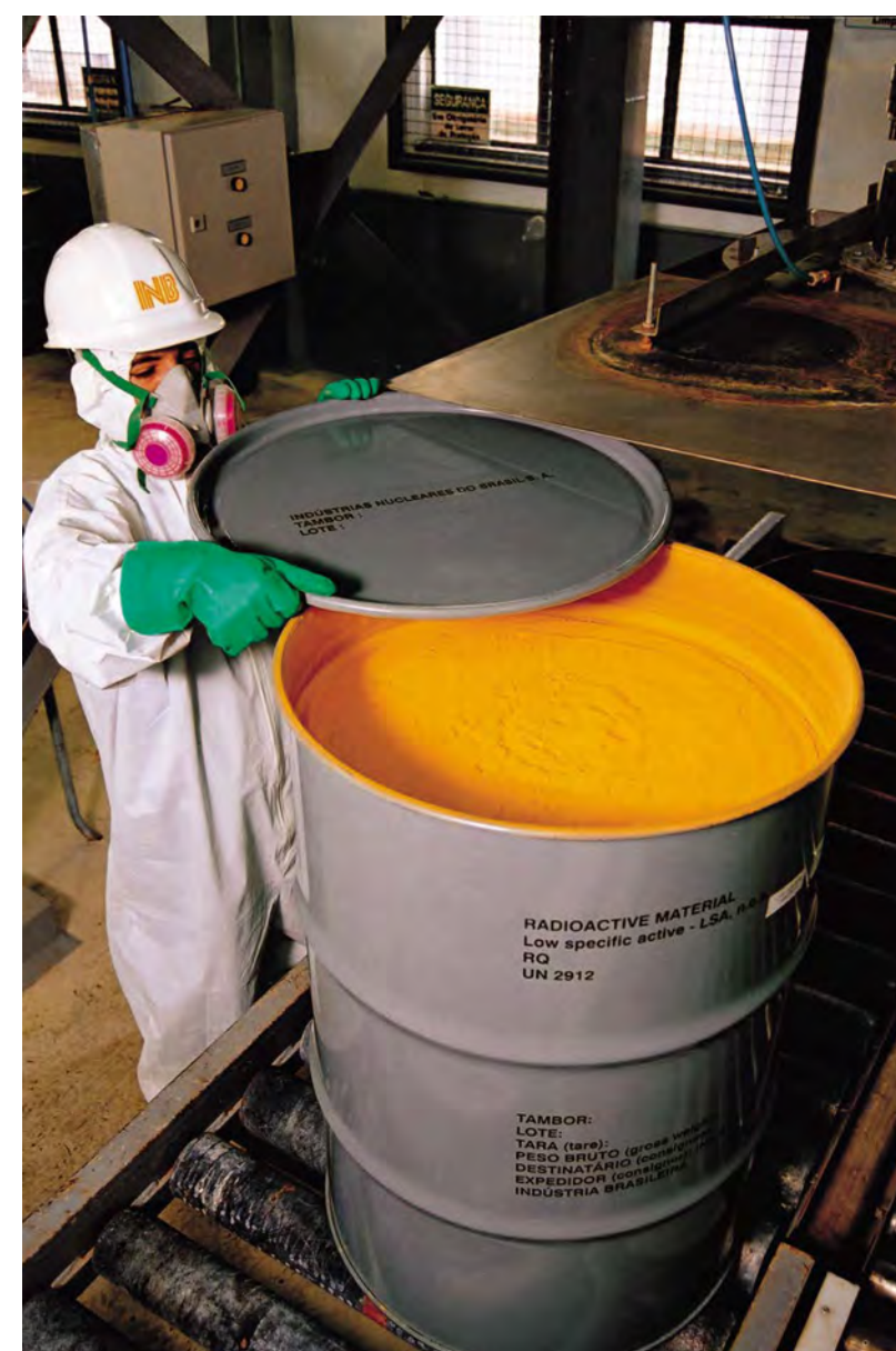
INB INDÚSTRIAS NUCLEARES DO BRASIL Processamento do Yellow Cake – Mineração (Foto: Igor Pessoa)
