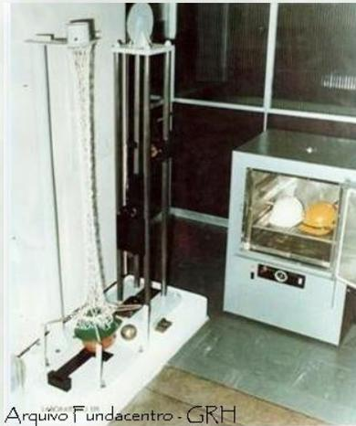
Iniciados estudos para a montagem do projeto do laboratório de ensaios e homologação de Equipamentos de Proteção Individual - EPI, concluído como projeto definitivo em 1977 e implantado no início de 1978. Os primeiros ensaios realizados abrangem capacetes, óculos e calçados.
