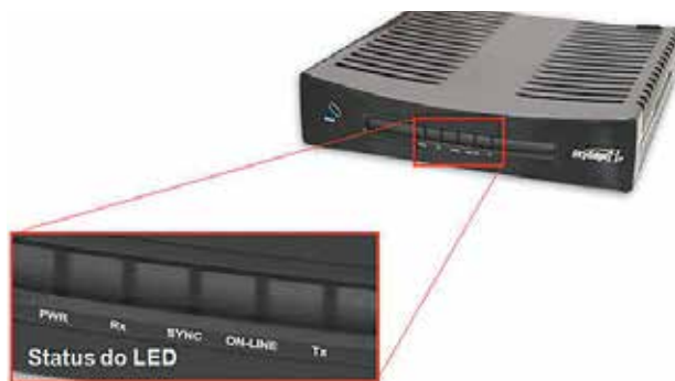
Figura 64: Problema de conectividade elétrica na IDU
