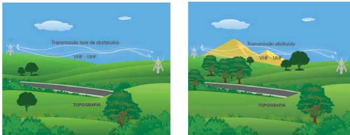
Figura 71: Obstáculos topográficos e perda de sinal
