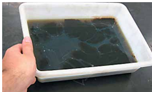
Figura 30: Óleo esbranquiçado, o que sugere folga no retentor da hélice
