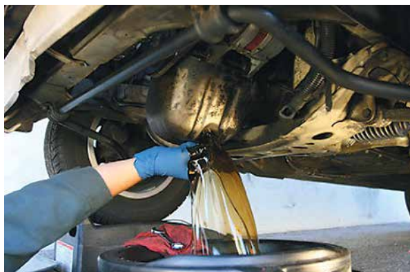
Figura 27: Troca de óleo por esgotamento
