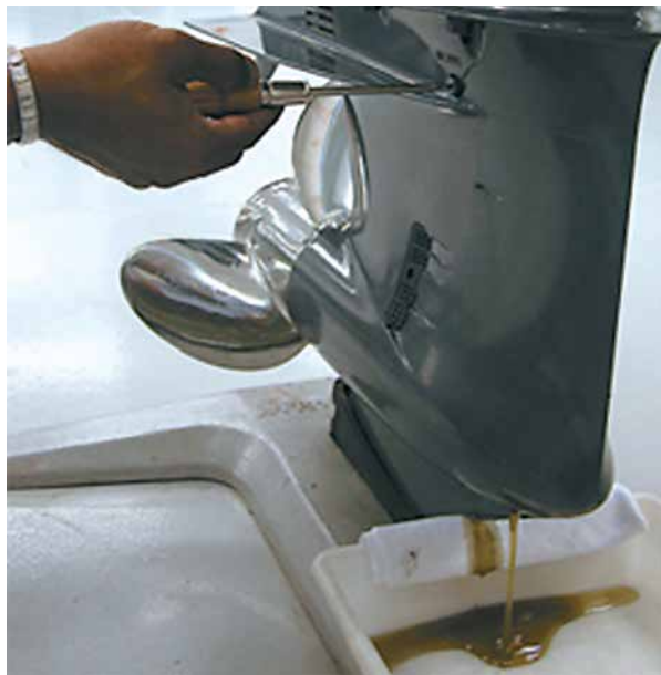
Figura 29: Troca de óleo sendo efetuada
