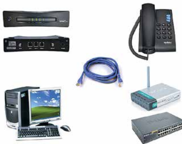
Figura 53: Equipamentos funcionais (IDU, telefone, PC, roteadores etc.)
