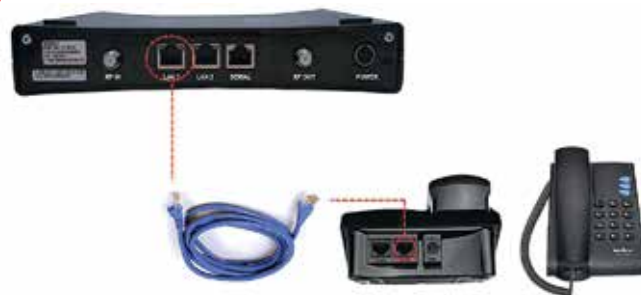
Figura 58: Conexão direta IDU-telefone
