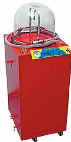
Figura 28: Troca de óleo por sucção
