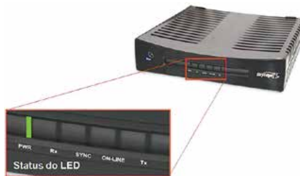
Figura 66: Problema de conectividade RF da IDU
