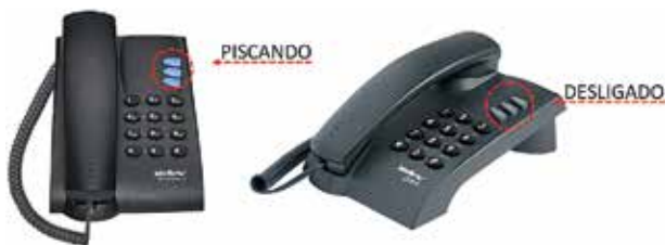
Figura 65: Problema de conectividade elétrica no telefone VoIP
