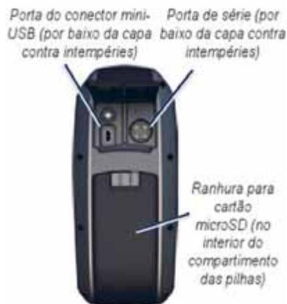
Figura 34: **Localização do conector mini-USB no GPSMAP 78.**
