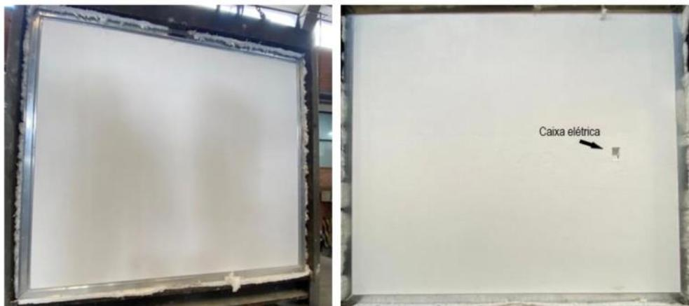
Figura 1 – Amostra ensaiada: (a) superfície não exposta, e (b) superfície exposta ao programa de aquecimento referente ao ensaio
