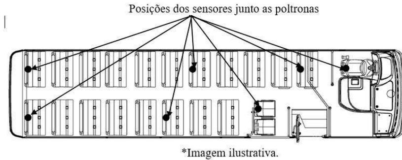
Os sensores devem ser posicionados na parte frontal do encosto, no centro da poltrona a uma altura de 600mm do assento, protegidos do fluxo direto das saídas de ar.
