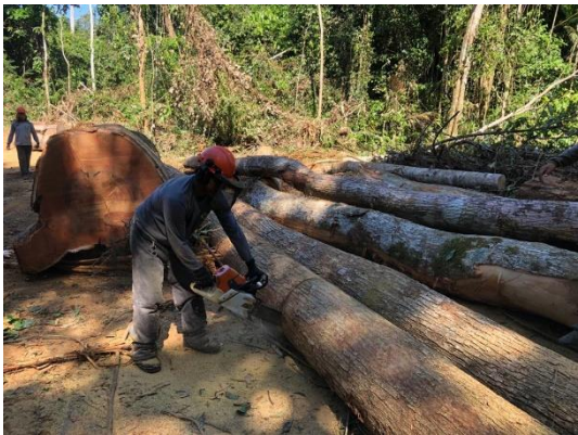
Figura 36: Traçamento das Toras no Pátio Florestal (Esquerda) e Medições e Pintura dos Pontos de Medição das Toras no Pátio Florestal (Direita).
