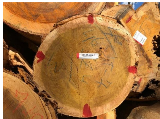
Figura 38: Exemplo de Controle de Custódia: Tora com os pontos de medição (cruzeta), Etiquetas de Controle: 1ª Etiqueta (Superior), 2ª Etiqueta (Centro) e 3ª Etiqueta (Centro-Inferior) (Esquerda) e 4ª Etiqueta (Inferior/Base) (Direita).
