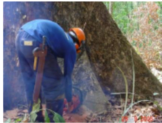
Figura 24: Corte vertical das Sapopemas (Esq.) e Corte Horizontal das Sapopemas (dir.).
