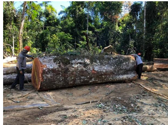
Figura 36: Traçamento das Toras no Pátio Florestal (Esquerda) e Medições e Pintura dos Pontos de Medição das Toras no Pátio Florestal (Direita).
