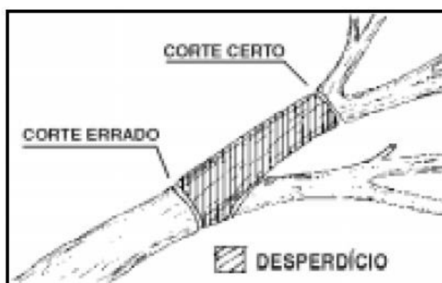
Figura 19 - Erro no destopamento. Fonte: Floresta para Sempre, IMAZON (1998).
