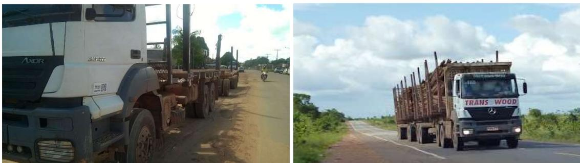
Figura 6 - Carretas de tração 6x4 utilizadas no transporte de madeira.
