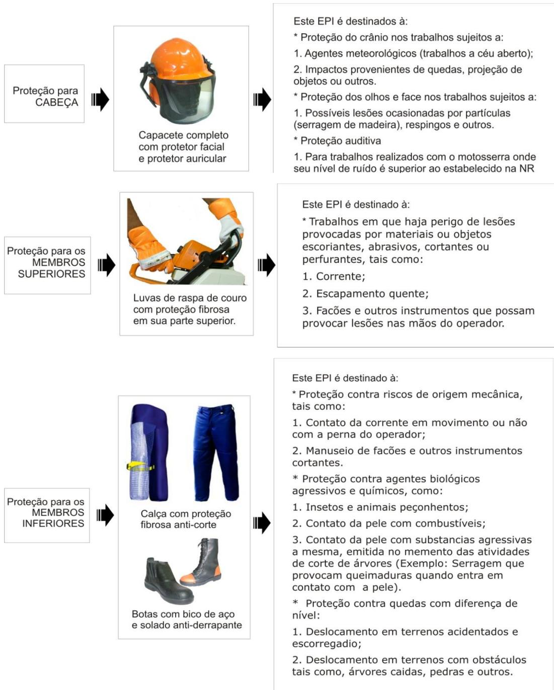
**Figura 8:** Equipamento de Proteção Individual para o motosserrista.
