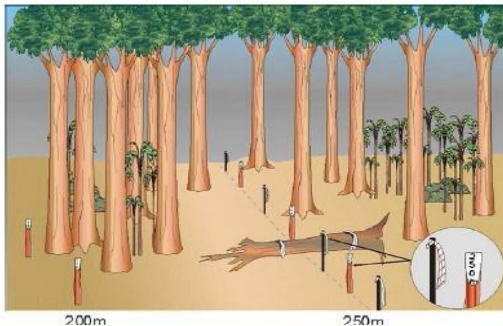
Figura 20: Localização da trilha base onde será construída a estrada.
