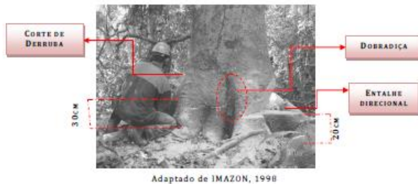
Figura 17: Corte Direcional das Árvores.
