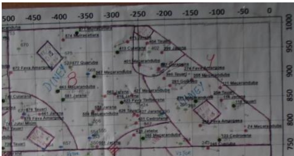
Figura 27. Exemplo de mapa de corte com a direção de queda das árvores
