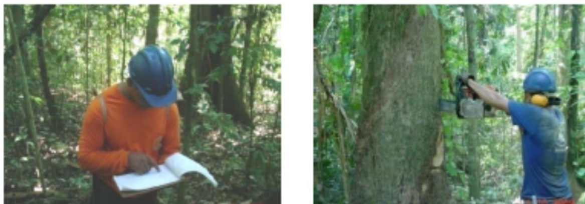
Figura 16: Localização das Árvores (Esq.) e Teste de Ocosidade no Tronco da Árvore (Dir.).
