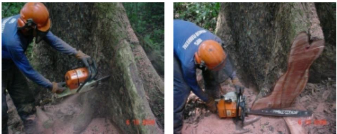
Figura 18: Corte Direcional das Árvores.
