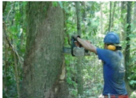
Figura 16: Localização das Árvores (Esq.) e Teste de Ocosidade no Tronco da Árvore (Dir.).
