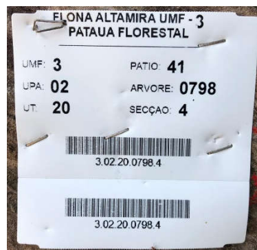
Figura 34: Plaqueta com código de barra e Identificação das Toras.
