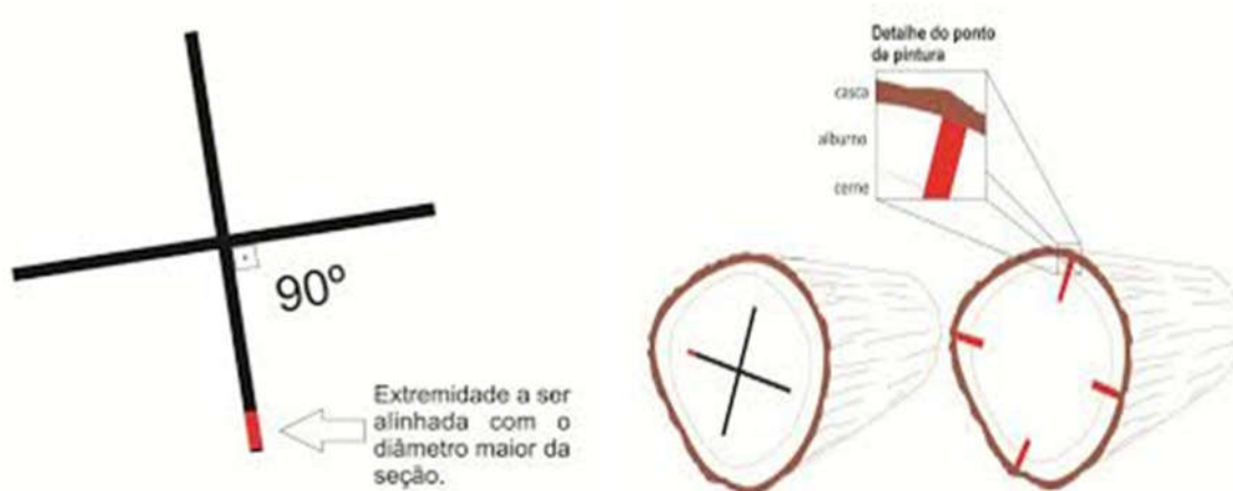
Figura 30: Marcação do ponto de medição do diâmetro cruzeta em toras uniformes 2 .
