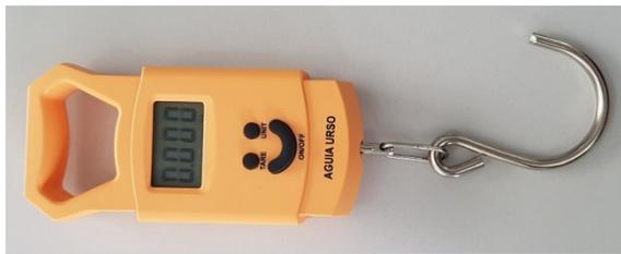
Figura 8 – Balança digital portátil com gancho para pesagem dos resíduos.
