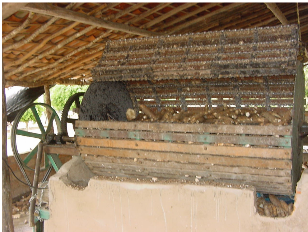
Figura II.2: Máquina de raspagem de mandioca Fonte: PAPL
