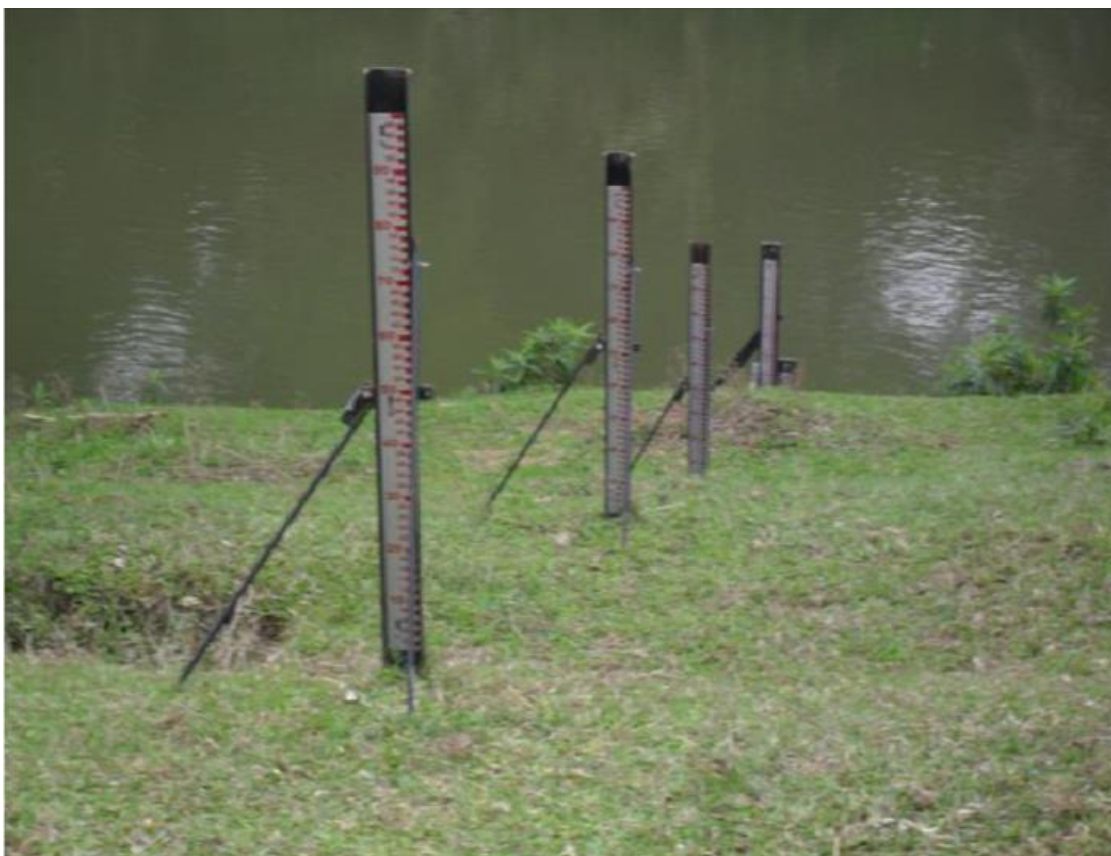
Figura 1 - Exemplo de seções de réguas linmétricas instaladas ao longo do terreno ANA (ANA, 2012).
