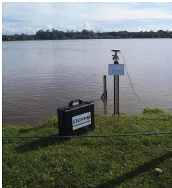
Figura 12 - Ocupação de um lance de régua por receptor GPS para nivelamento da estação fluviométrica de Porto União.
