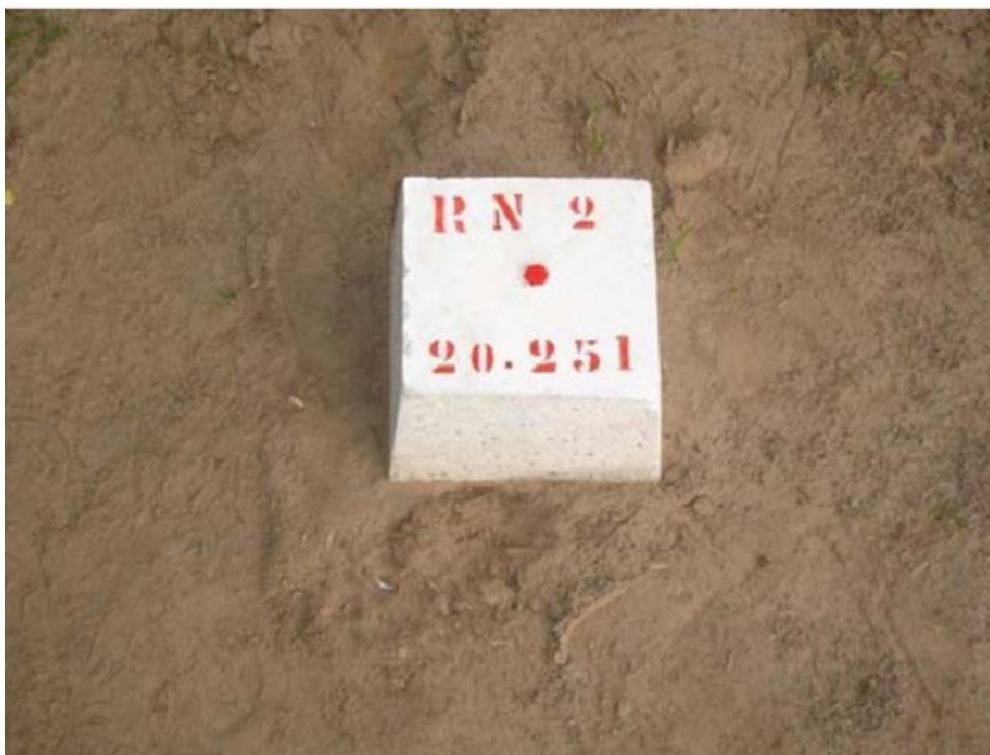
Figura 11 - Referência de nível (RN) utilizada para nivelamento das réguas linimétricas, com referência arbitrária.
