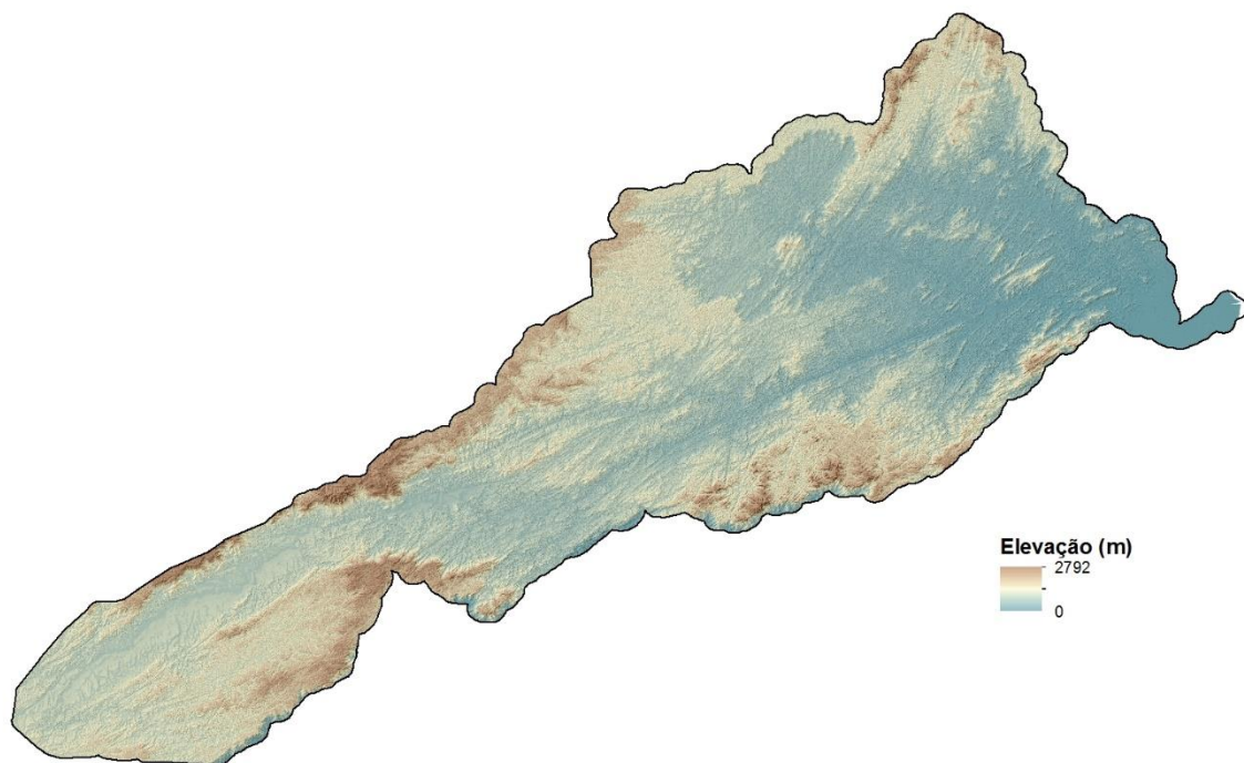
Figura 3.1.1 - MDE produzido a partir dos dados do SRTM de 90 metros para a bacia do Rio Paraíba do Sul.
