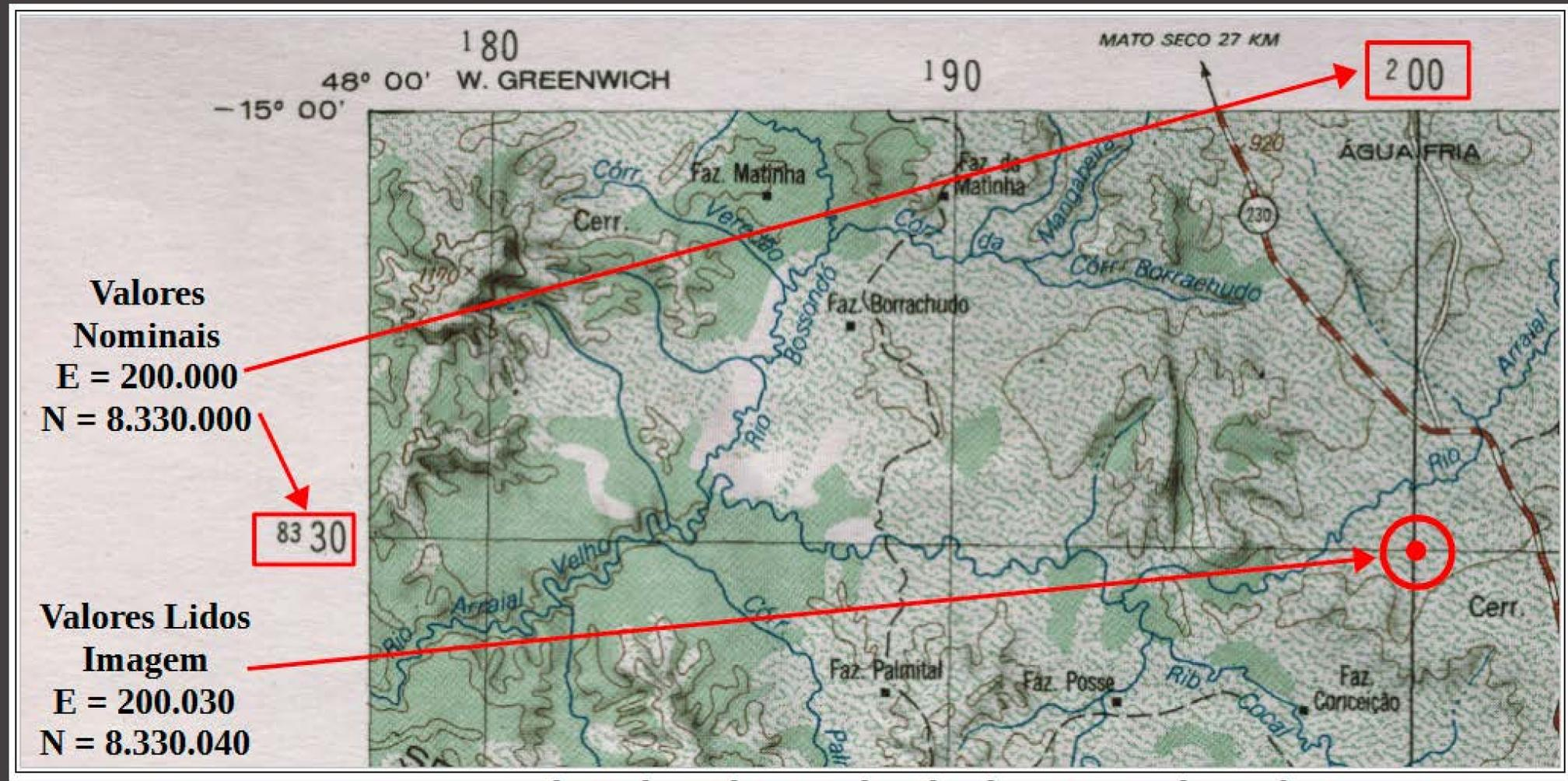
**Figura 11** - Comparação dos Valores das Coordenadas de um Ponto de Verificação
