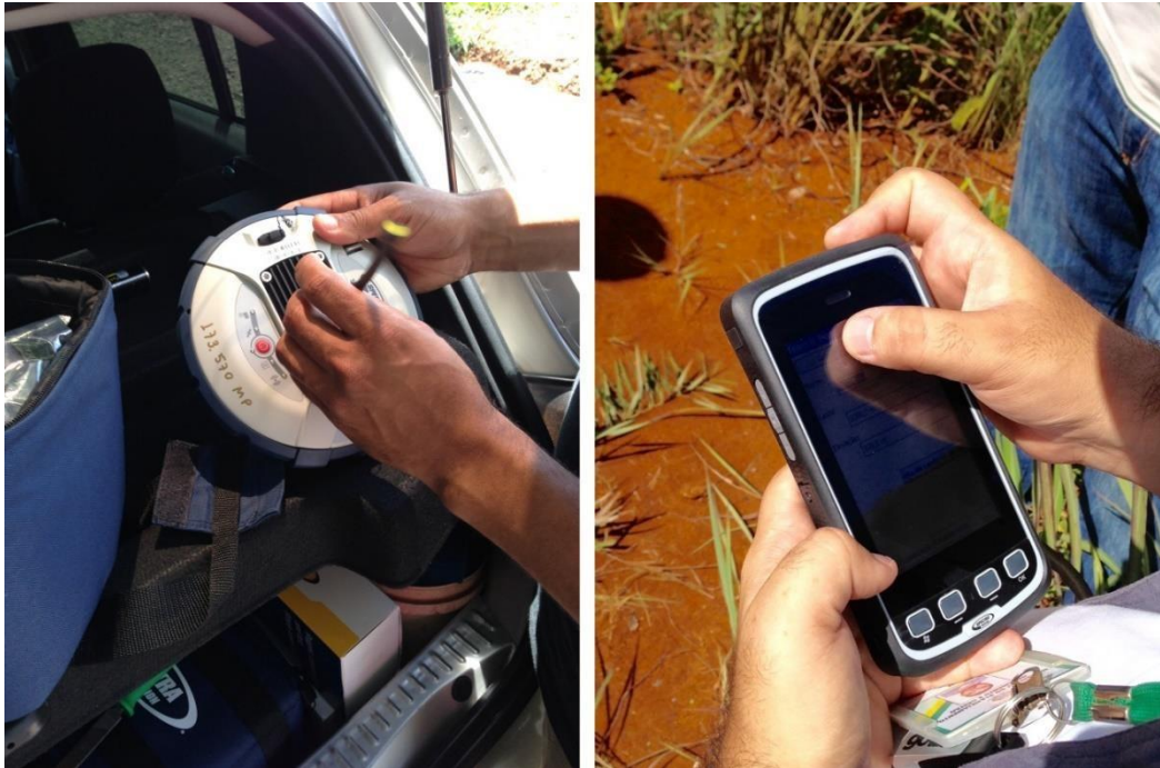
Figura 10: Montagem dos receptores e configuração da coletora.
