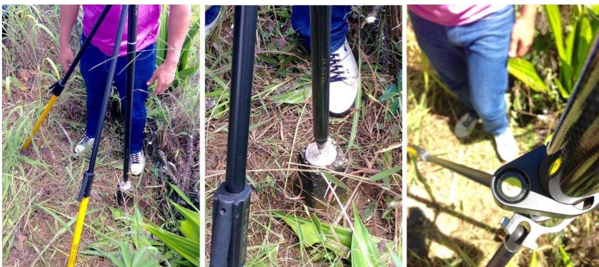
Figura 13: Instalação do bastão no bipé da maneira correta de forma vertical em relação ao marco geodésico. A bolha no centro (terceira foto) mostra a posição correta dos instrumentos.
