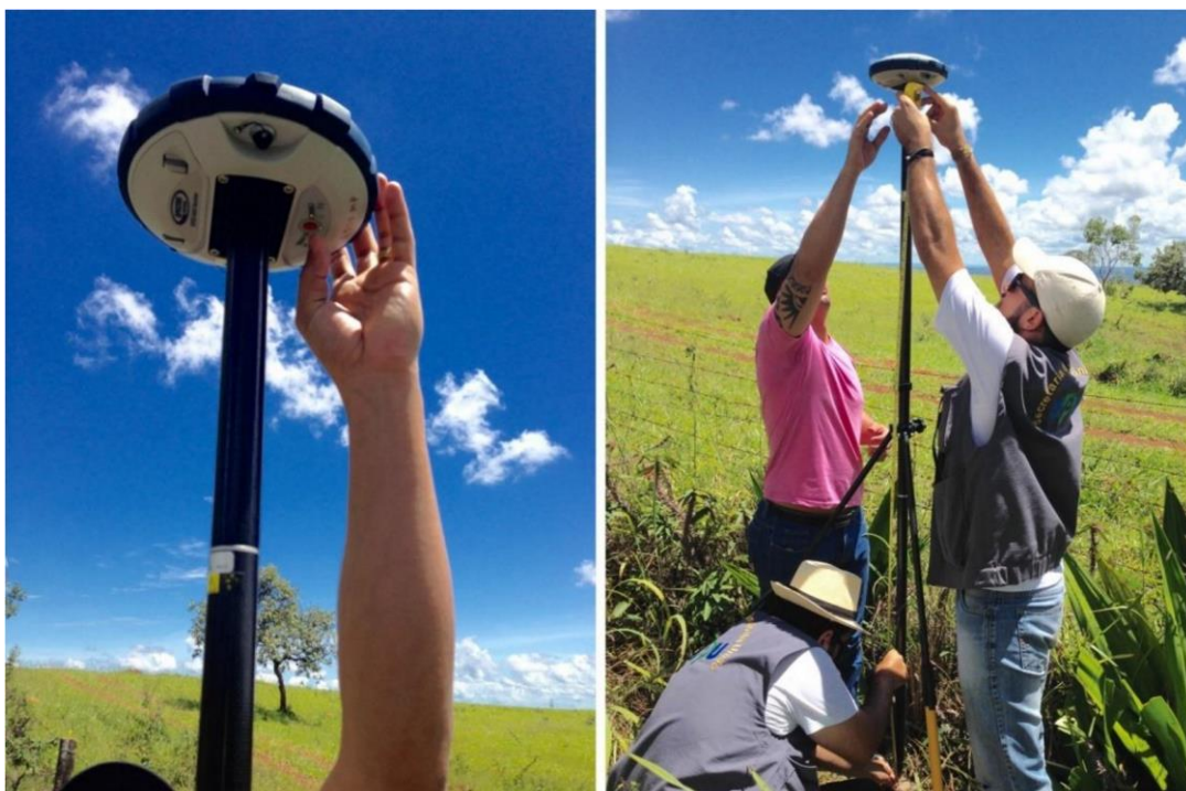
Figura 14: Ligando o receptor após ser instalado no bastão do bipé; Medindo a altura do receptor até o marco geodésico.
