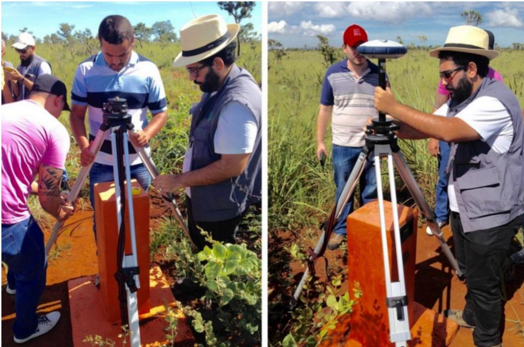
Figura 11: Instalação do tripé e do receptor, após o nivelamento do tripé sobre o ponto materializado.
