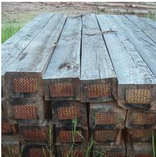
Figura: Dormentes usados de eucalipto Citriodora com proteção anti-rachante
