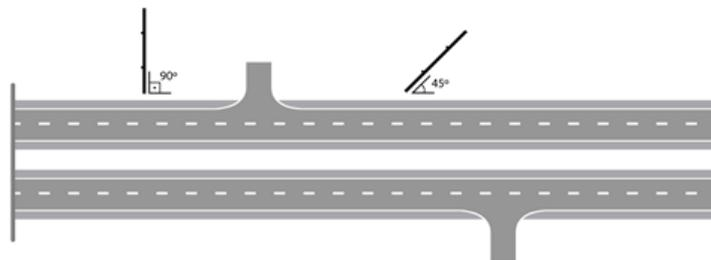
A aferição do ângulo de dispositivos instalados em curvas deverá ser realizada em relação a uma linha tangente a curva, conforme ilustrado na figura 4.
