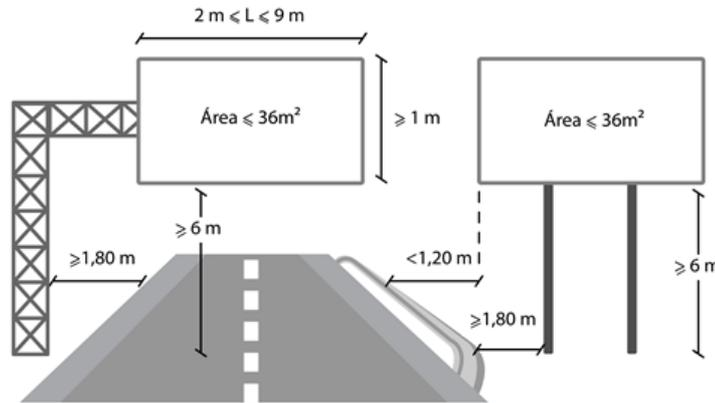
Os painéis deverão ser fixados formando um ângulo mínimo de 45° (quarenta e cinco graus) e máximo de 90° (noventa graus) em relação ao eixo longitudinal da rodovia, conforme ilustrado na figura 3 abaixo.
