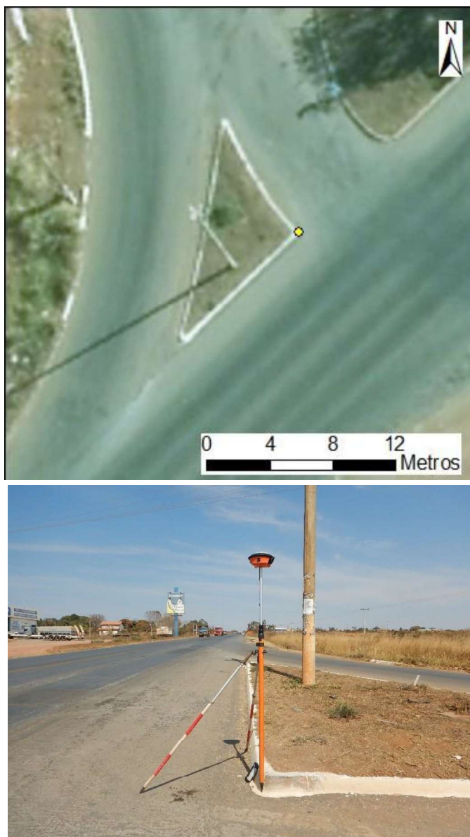
Figura 1: Ponto fotoidentificável coletado na quina de um canteiro de sistema viário.
