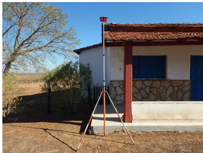
Figura 2: Ponto fotoidentificável coletado em quina de telhado.
