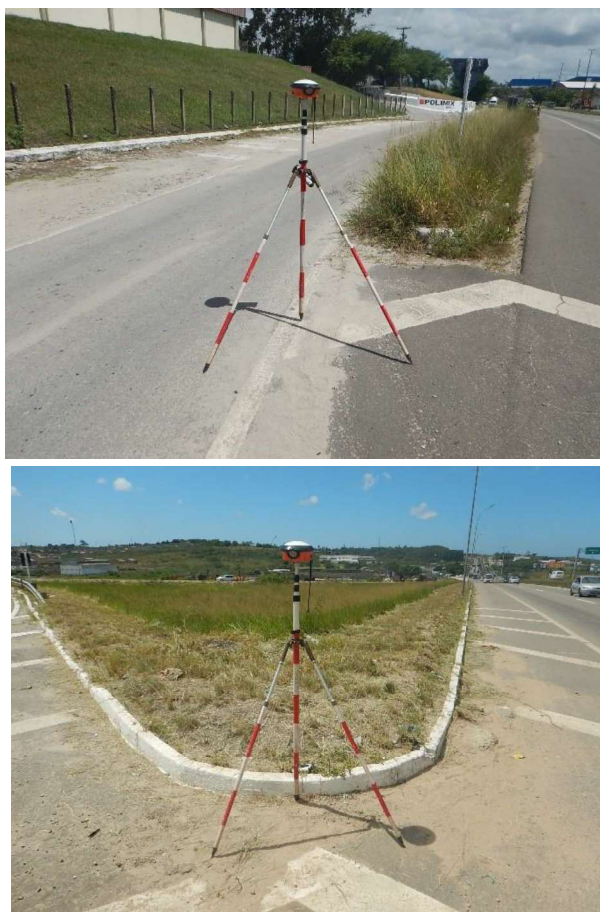
Figura 5: Exemplos de feições não fotoidentificáveis - sinalização horizontal coberta por areia (esquerda) e canteiro central em formato circular (direita).
