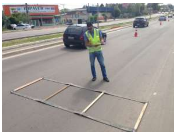
Figura 11 – Execução do levantamento dos defeitos
