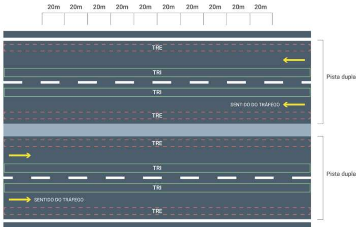
Figura 10 – Levantamento deflectométrico na TRE com o FWD, pista dupla
