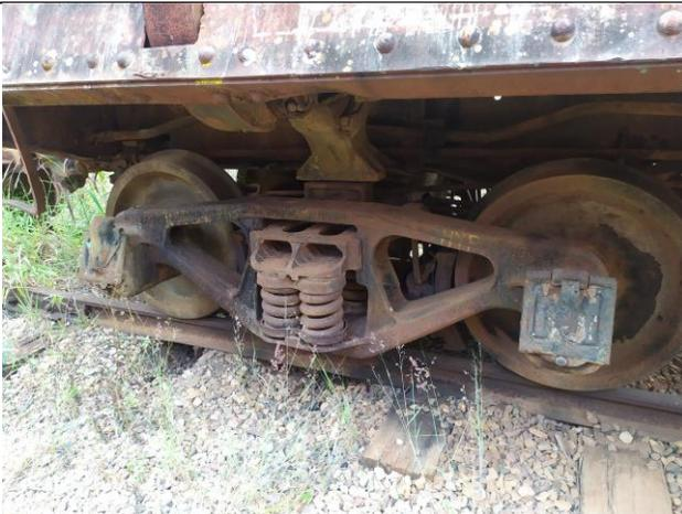
Foto 08 – Truque 02 com Caixa de Graxa e Sapatas de Freio
