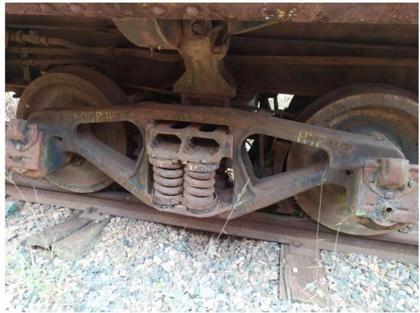
Foto 07 – Truque 01 com Caixa de Graxa e Sapatas de Freio
