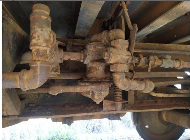
Foto 09 - Encanamento geral, válvulas de controle, timoneria de freios.
