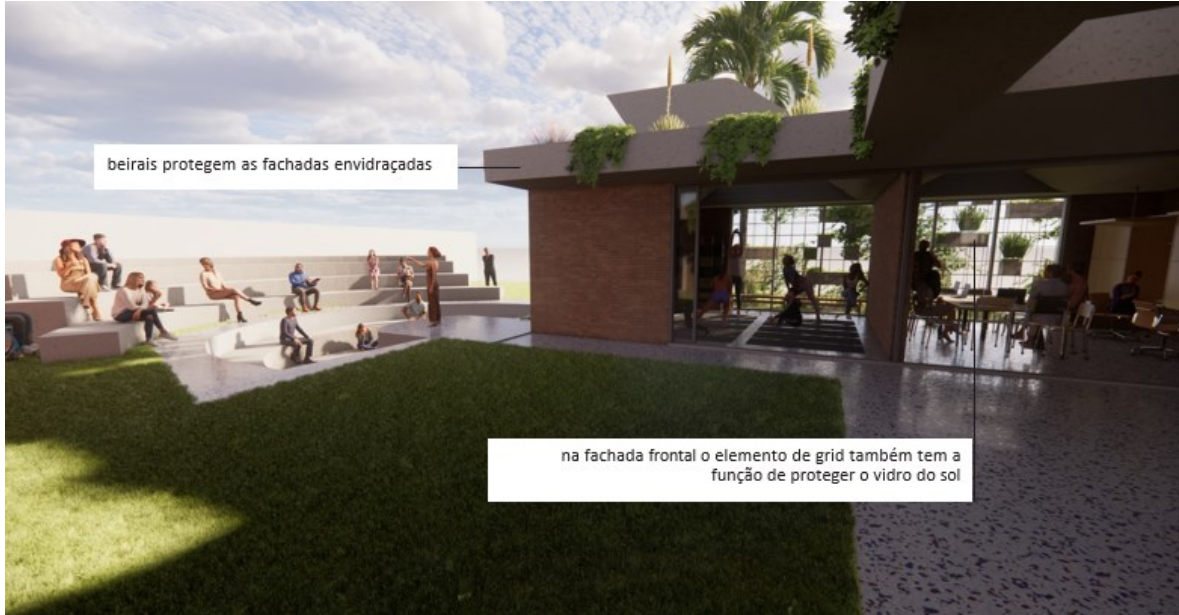
Figura 10 – fachadas envidraçadas protegidas de insolação direta.
