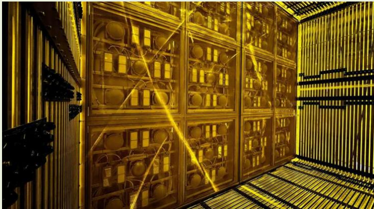
Detectores X-Arapuca instalados no Fermilab, nos EUA.
