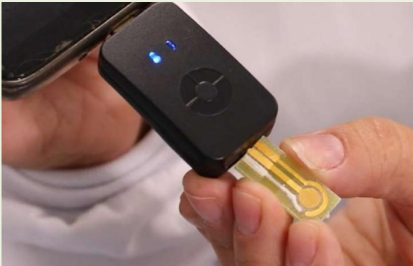
Protótipo do biossensor em funcionamento em um aparelho celular
