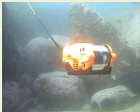
Inspeção em açudes Fonte: SWART (2011)
