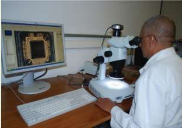
Caracterização de falhas em circuitos e componentes eletrônicos Fonte: CTI (2011)
