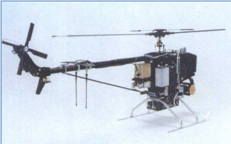
Mini-helicóptero, um VANT (Veículo Aéreo Não Tripulado)
