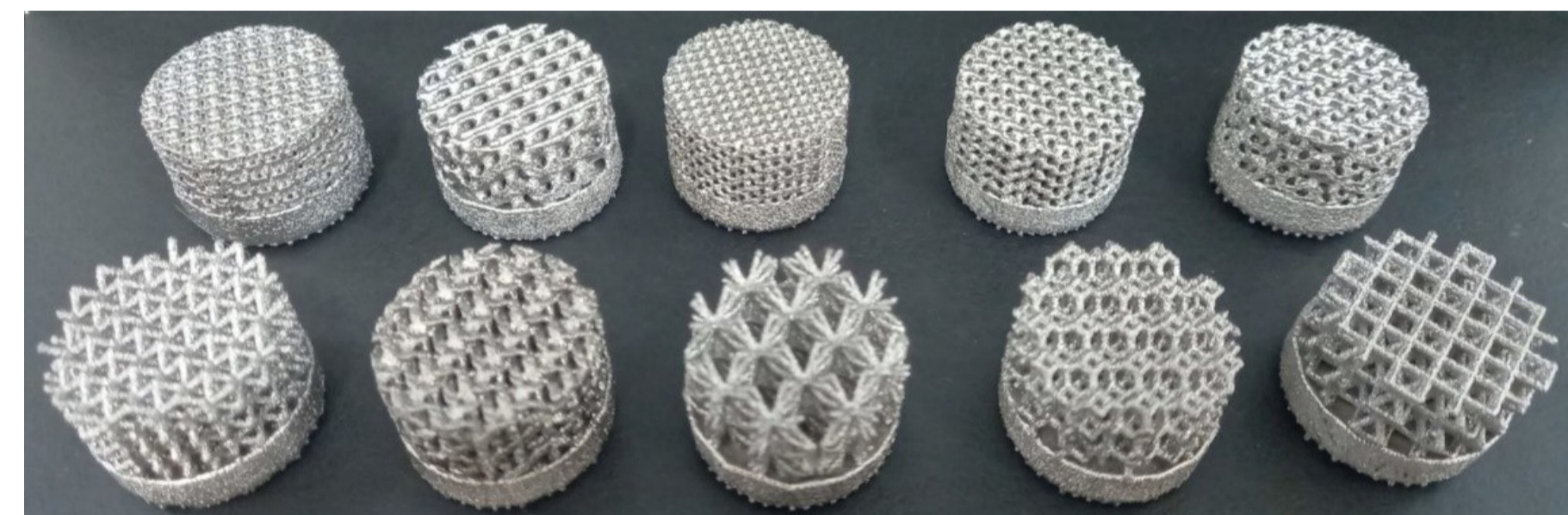
Figura 4. Estruturas lattice para estudo de fabricação de peças com aplicação para scaffolds , fabricadas em Ti6Al4V por EBM.
