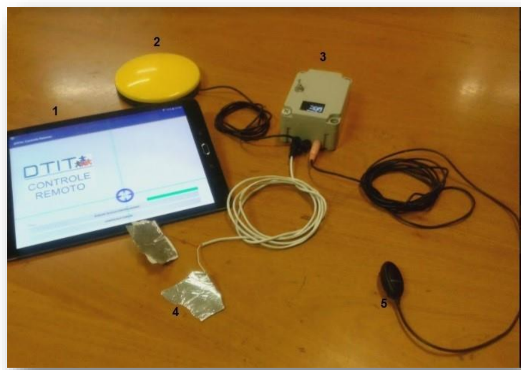
Fig. 2. 1. Tela do Tablet; 2. Periférico acionador; 3. Caixa modelo Patola – BPL100; 4. Pads para sensores capacitivos feitos de manta metálica autoadesiva; 5. Microfone. Fonte: Imagem captada durante o desenvolvimento
