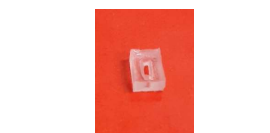
Figura 1. Célula em PDMS com dimensões externas de 0,7x0,5x0,2mm e internas de 0,33x0,11x0,3mm
