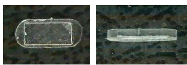
Figura 2. Célula com um retângulo interno de 3,66x1,9x0,1mm e paredes de 0,3 e 0,1mm
