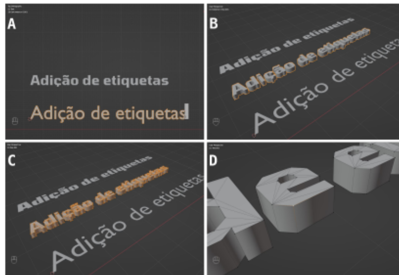
Figura 3: Capturas de tela do software Blender mostrando as etapas para geração de textos tridimensionais. A) Modificação do texto em Modo de Edição, B) extrusão do texto central na fonte Tomorrow Bold , C) transformação do modelo de modo curva para malha e D) destaque na malha com a seleção de um vértice na letra "e".
