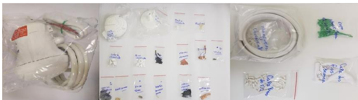
Figura 2 – Detalhe de todas as partes do chuveiro elétrico após desmontagem e separação
