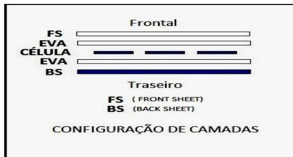
Figura 1 – Configuração do modulo flexível
