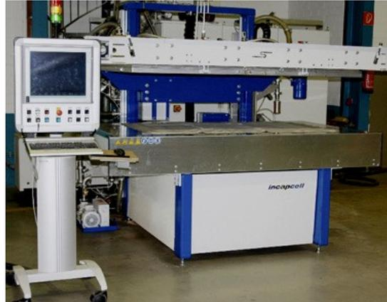
Figura 2 – Máquina laminadora do modulo flexível
