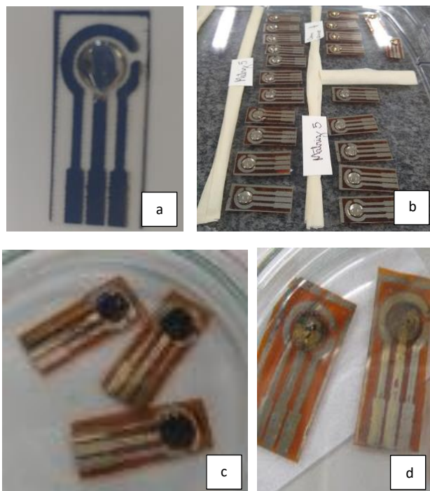
Figura 3: Testes de resistência e molhabilidade realizados com os sensores impressos 3(a) teste da gota 3(b) adição de agentes químicos nos sensores, 3(c) incorporação de biomassa e PVDF no eletrodo de trabalho e 3(d) desprendimento da biomassa e decomposição parcial dos sensores
