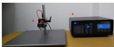
Figura 4 – Equipamento quatro pontas Jandel 3000+, (A) sonda de medida, (B) unidade de teste RM3000
