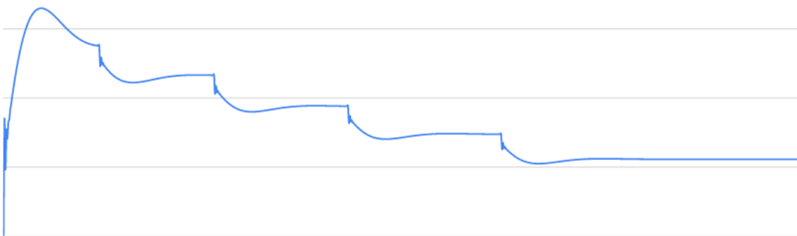
Figura 4. Controle PID do PWM do cooler
