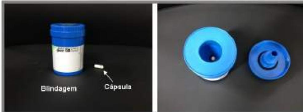
**Figura 3 – Blindagem de Chumbo Grande para múltiplas cápsulas de Iodo 131**
