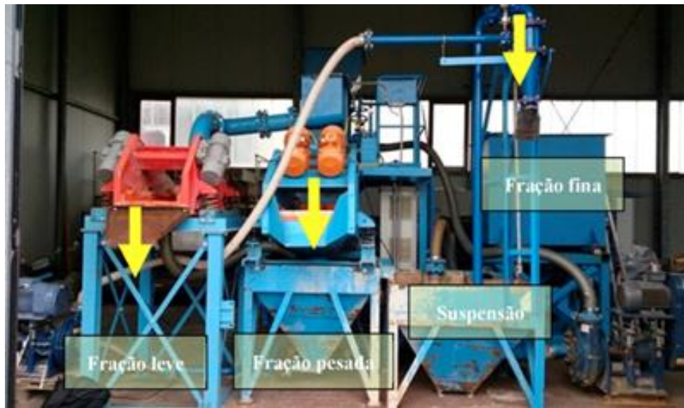
Figura 12 – Coqueteleira úmida “Triplo A” da “AGS Instalações + Método GmbH
