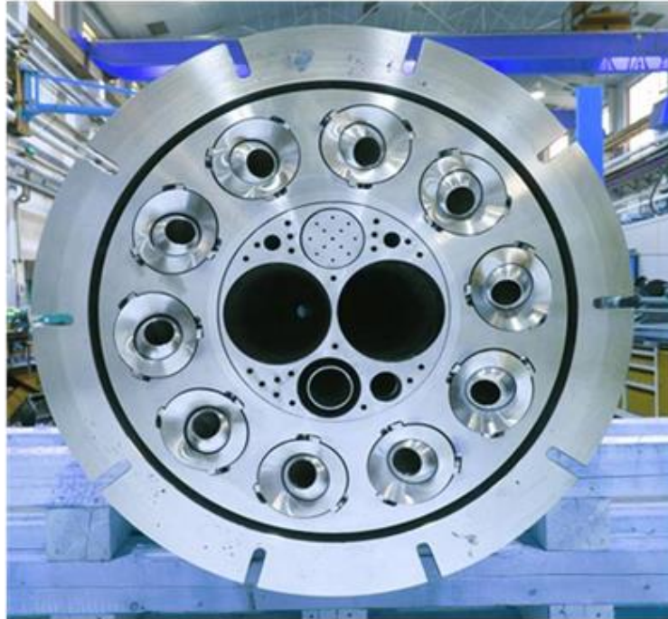
Figura 2 – Vista frontal de um queimador adaptado para a zona de clínquerização
