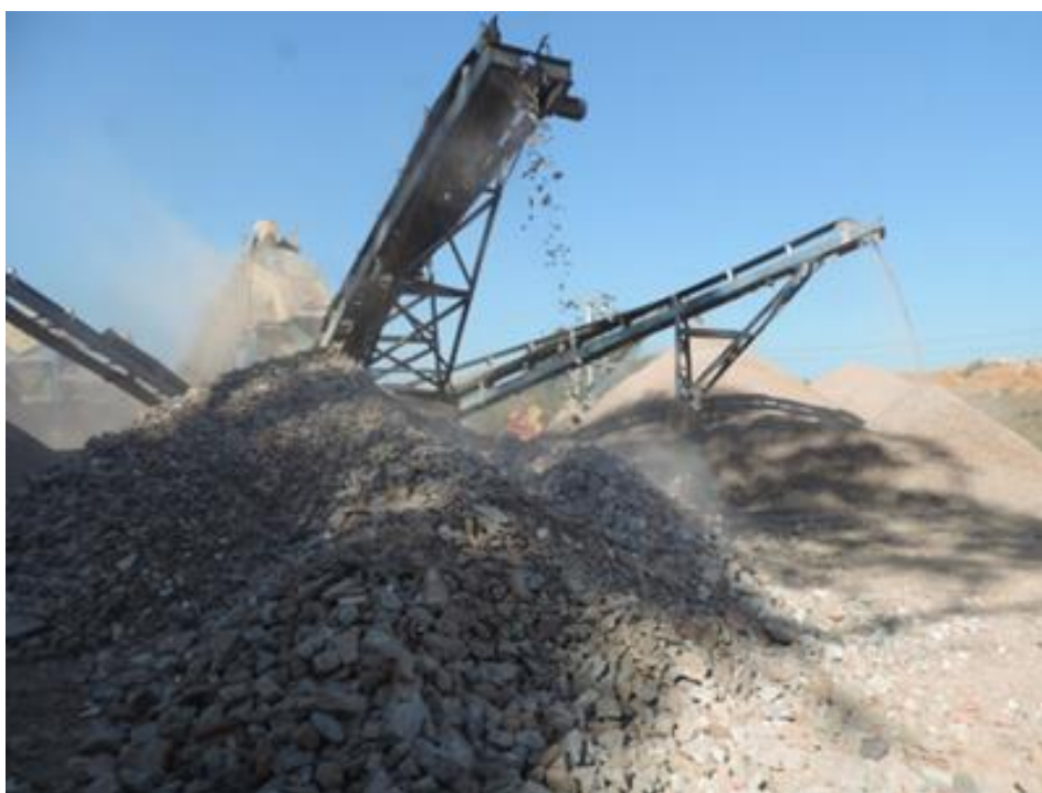
Figura 11 – Deposição do material conhecido por Brita 3
