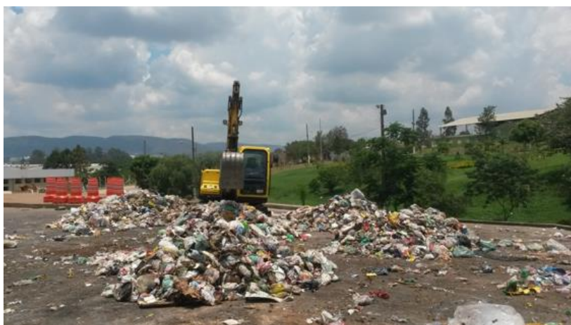
Figura 2 – Quarteamento dos RSU coletados para amostragem no GERESOL
