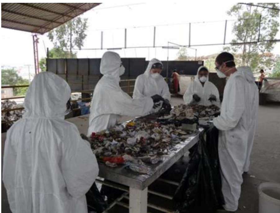
Figura 10 – Segregação dos materiais de uma classe na mesa de triagem
