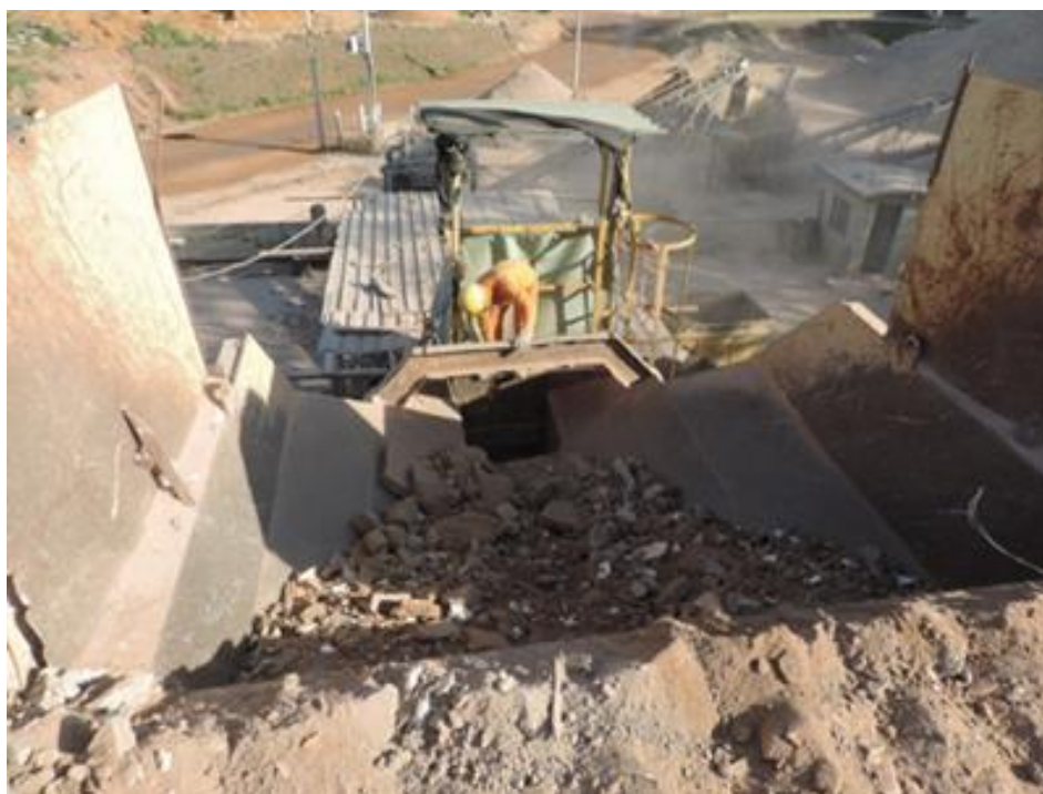
Figura 8 – Início do processo de britagem
