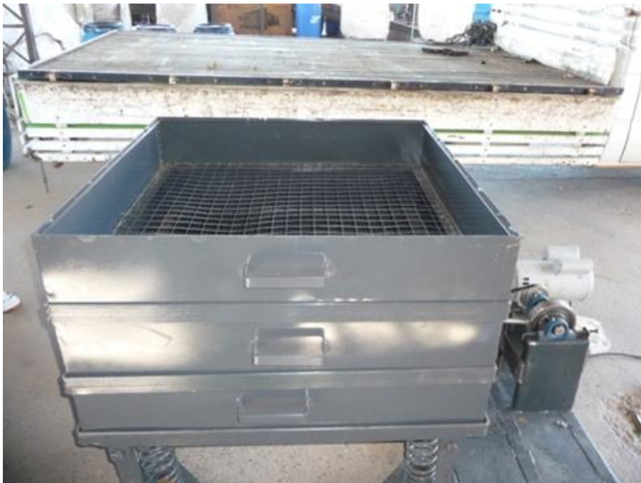
Figura 4 – Peneirador vibratório, com as malhas de 20 e 40 mm
