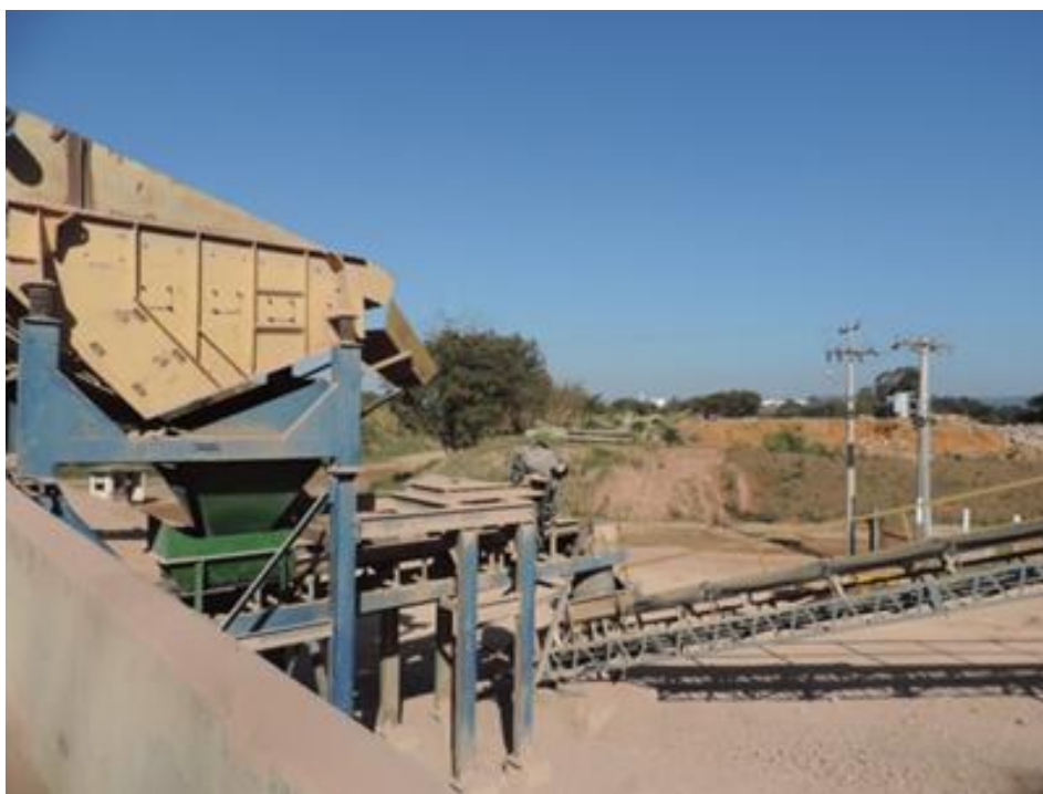
Figura 10 – Peneiramento granulométrico dos materiais
