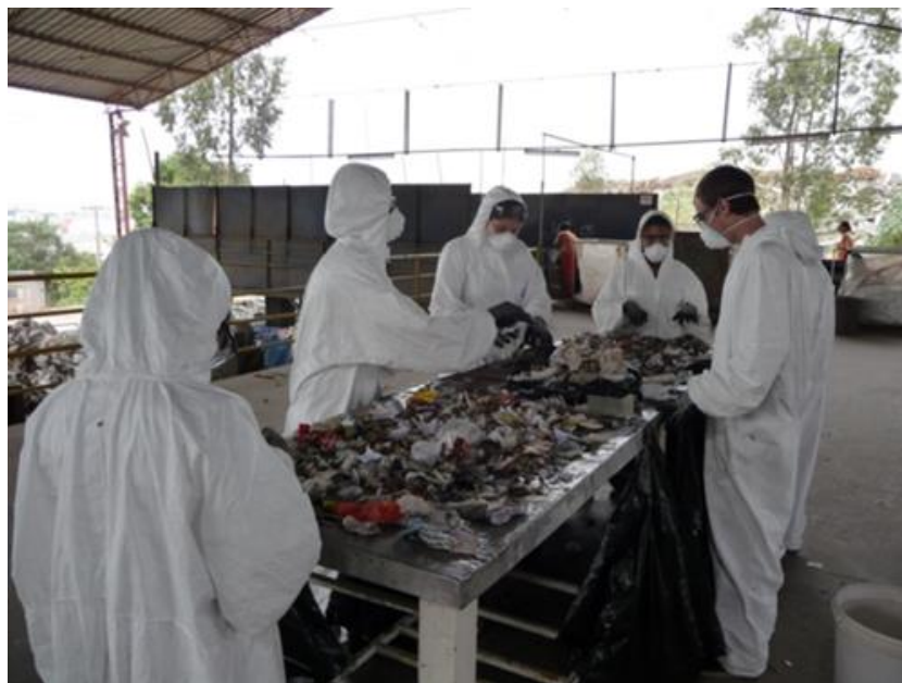
Figura 6 – Segregação dos materiais de uma classe na mesa de triagem
